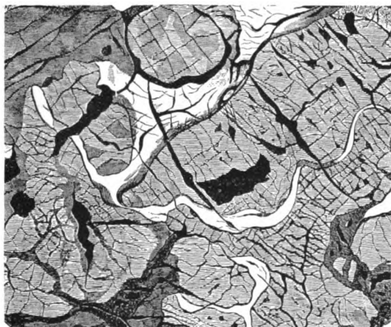
Angeschliffenes Meteoreisen von Santa Catharina (Brasilien) mit Einschlüssen von Graphit.
