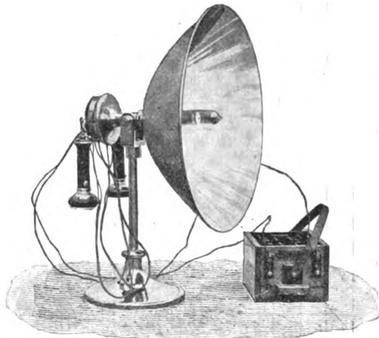
Fig. 2. Empfangsapparat für Lichttelephonie, System Ruhmer.
