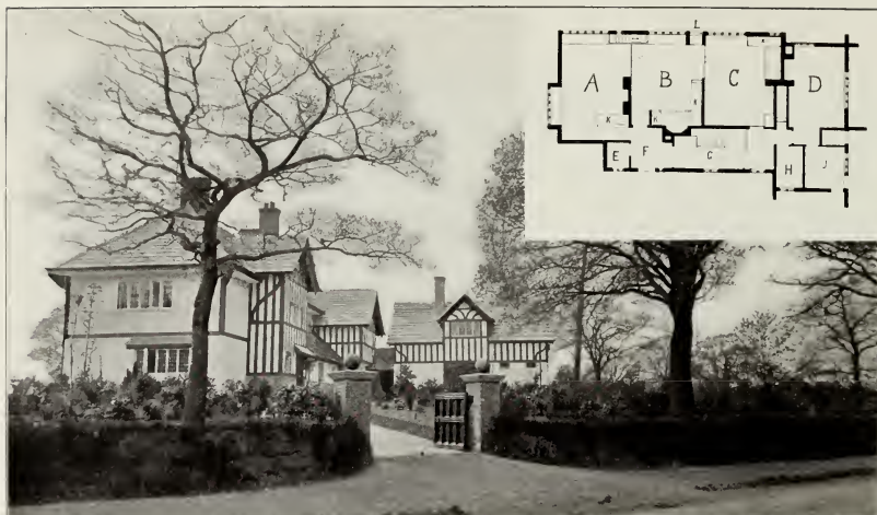
M. H. BAILLIE SCOTT-DOUGLAS NORDOSTANSICHT UND GRUNDRISS EINES LANDHAUSES IN KNUTSFORD A. WOHNZIMMER, B. HALLE, C. SPEISEZIMMER, D. KÜCHE, E. GARDEROBE, F. EINGANG, G. FLUR, H. SPEISEKAMMER
