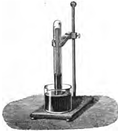
Apparat zur Trennung des Stickstoffes vom Sauerstoff.
