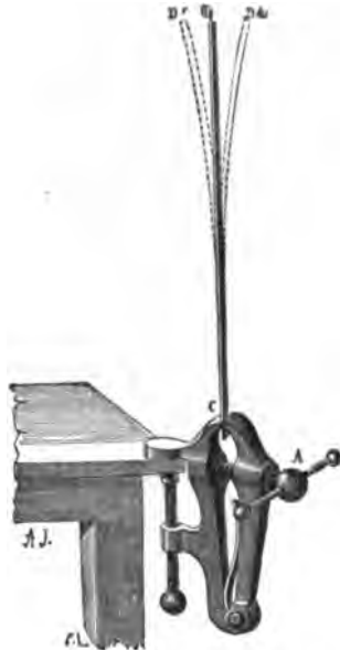
Schwingungen eines elastischen Metallstreifens.
