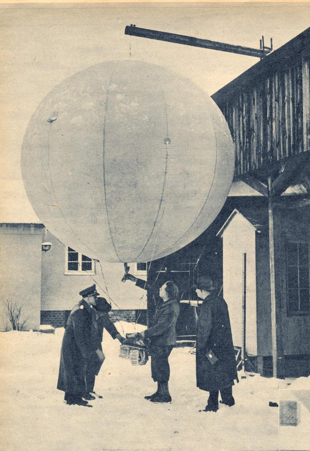
Das obige Bild zeigt die ganze Anlage des englischen Flugblattballons. Es besteht aus gummiertem Baumwollstoff, der mit Wasserstoffgas gefüllt ist. Unter dem Ballon hängt ein Holzrahmen mit den zum Abwurf bestimmten Flugblättern
