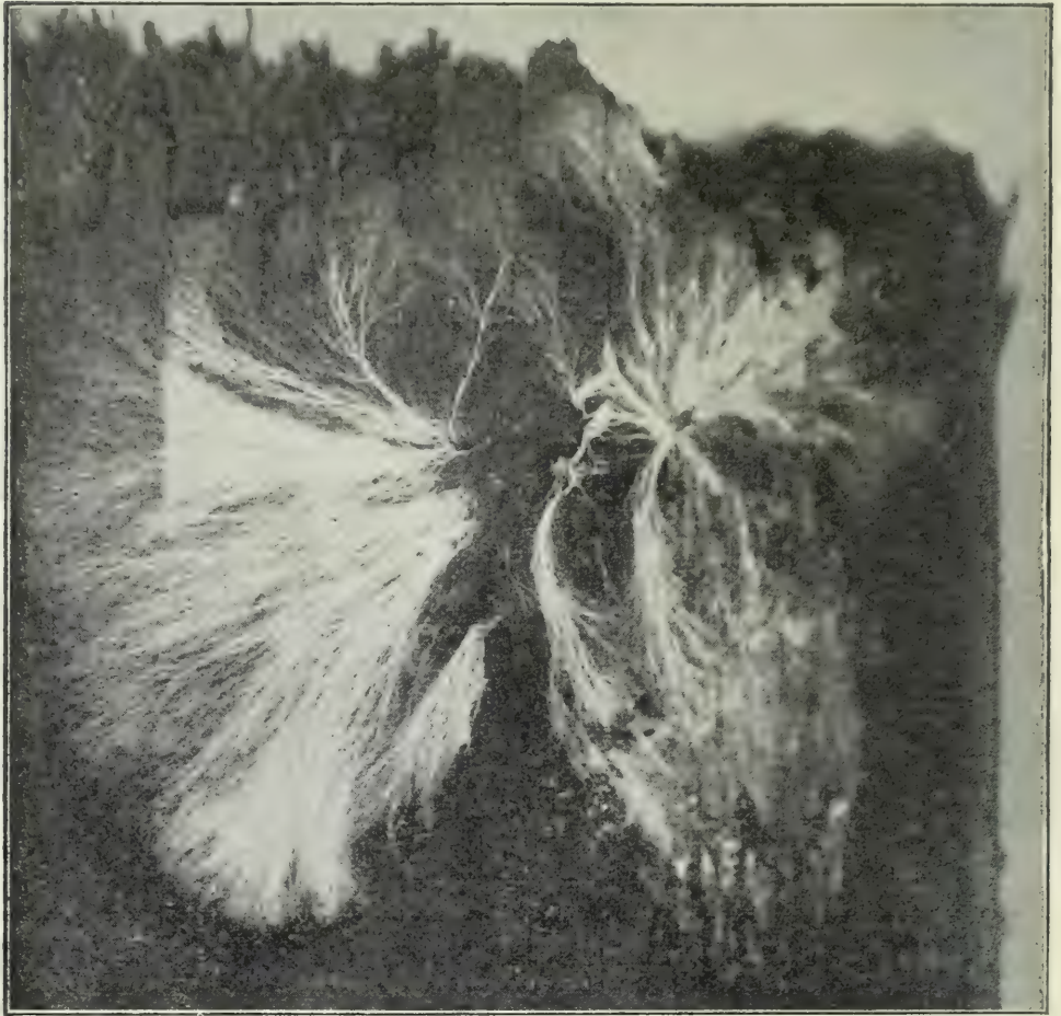
Fig. 89. Coniophora cerebella . Mycel auf einem Balkenstück. Natürliche Grösse.
