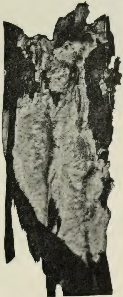
Fig. 83. Corticium giganteum . Fruchtkörper auf einem zerstörtem Dachsparren. \frac{1}{2} der natürlichen Grösse.
