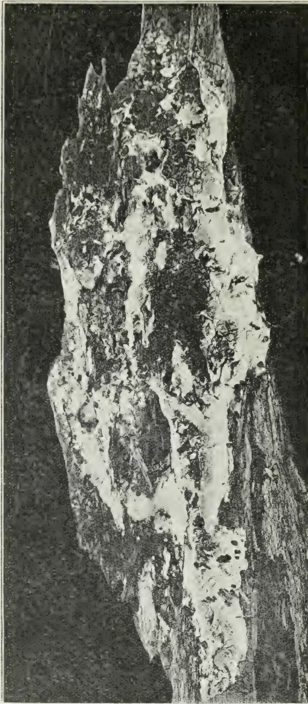
Fig. 18. Merulius lacrymans . wilde Form. Fruchtkörper auf zerstörtem Kiefernholz. \frac{3}{4} der natürl. Grösse.
