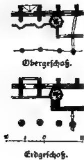
Abbildg. 17—19. Emporen-Anlage auf der Nordseite der St. Marien-Kirche in Zwicau.
