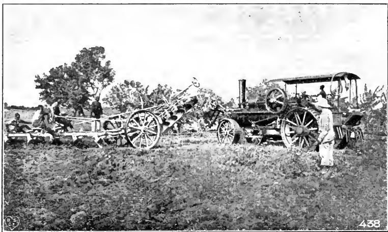
Kemna's Heissdampfplug auf der Plantage Kingwagwanda am Mbumifluß der „Deutschen Rufiji-Baumwollgesellschaft“ in Tätigkeit.
