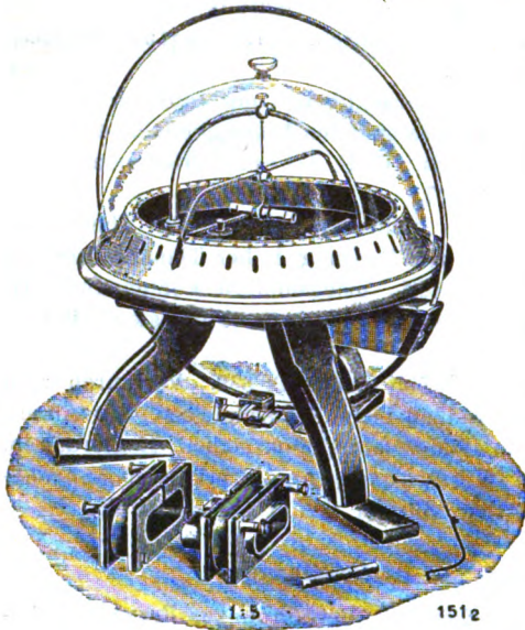
Schulgalvanometer mit Tangenten-Boussolenring.
