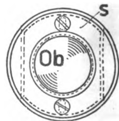
Fig. 4. Verstellbares Objektiv für die Höhenkorrektur beim Beschuß des Zielfernrohres.
