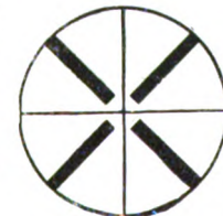
Fig. 9. Absehen (Visiermarke) für das Zielfernrohr zum Tag- und Nachtgebrauch.
