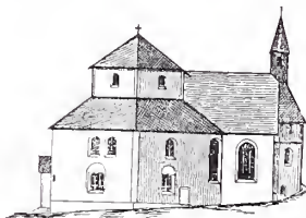
Abbildung 5. Zentralbau mit Vierung und Apsis. (Der Dachreiter falsch, müßte auf dem Satteldache der Vierung stehen).
