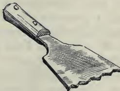
sort par le lit supérieur de la pierre, c'est que la pierre est bien fichée et que sa queue est remplie. Alors, et après que ce mortier a acquis de la consistance, on le bourre au moyen du refouloir de fer (fig. 2). Il est bon de laisser 2 à 3 centimètres de vide sous le lit, le long du parement. On remplit ce vide, plus tard, en rejointoyant ; c'est le moyen de s'assurer que la pierre ne pose pas sur ses arêtes et qu'elle ne s'épaufrera pas sous la charge.
