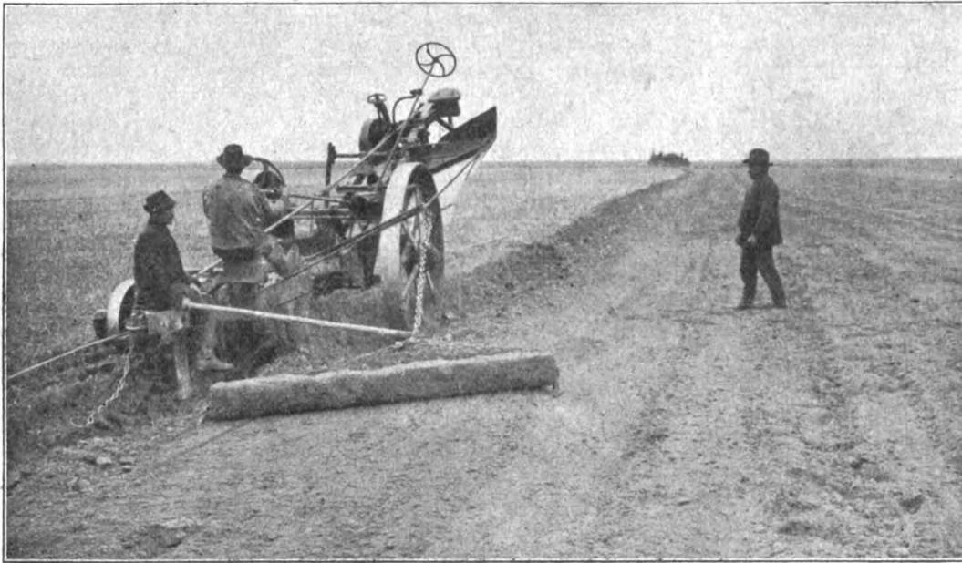
Maschinenarbeit in der neuen Baumschule der Firma Späth in Ketzin. Bild 1. Vorbereitung neuen Geländes mit Hilfe des Rigol-Dampfpfluges.
