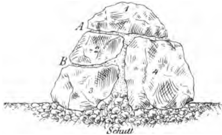
Fig. 7. Unpraktische Gruppierung der Steine (Durchschnitt), da durch Stein 1 von obenher die Zuleitung von Wasser abgehalten wird.
