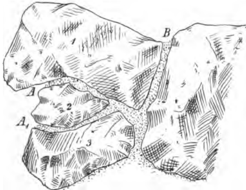
Fig. 4. Unpraktische Lage der Steine einer Felsgruppe (Durchschnitt), da nach A und A 1 kein Wasser gelangen kann.
