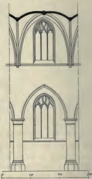
Bild 11. Gent. Jesuitenkirche. System des Mittelschiffes (Rekonstr.).
