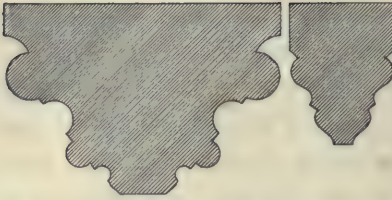
Bild 7. Mons. Profil der Arkaden und Diagonalrippen der früheren Jesuitenkirche.
