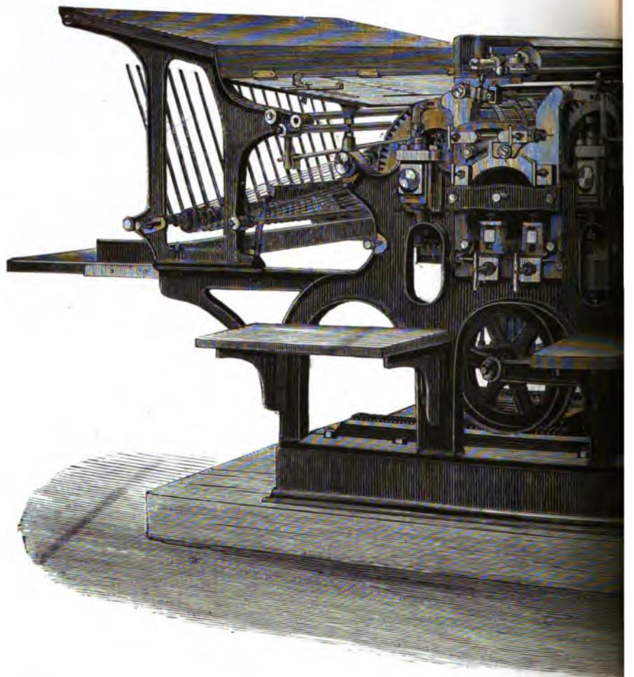
Doppel-Schneltpresse mit Eisenkugelschnecke
