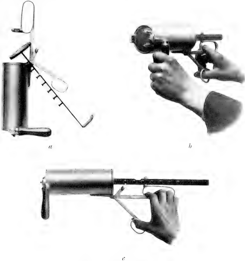
Fig. 230. Jankesche Leimspritze. a Stempel herausgenommen, b und c im Gebrauch (ein- und zweihändig).
