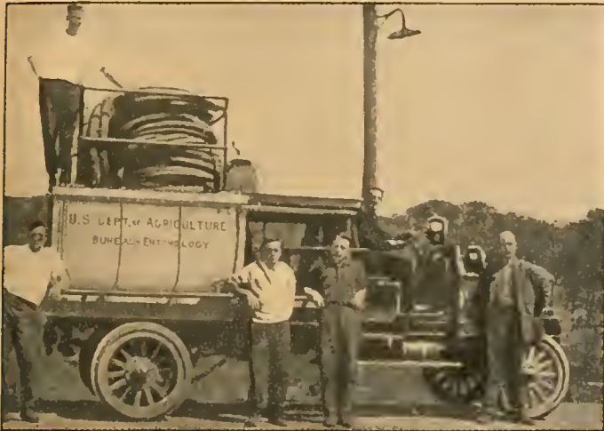
Amerikanischer Motorspritzwagen zur Schädlingsbekämpfung. (Nach Worthley, U. S. Dept. of Agriculture, Bul. 480.) (Text siehe Seite 86.)
