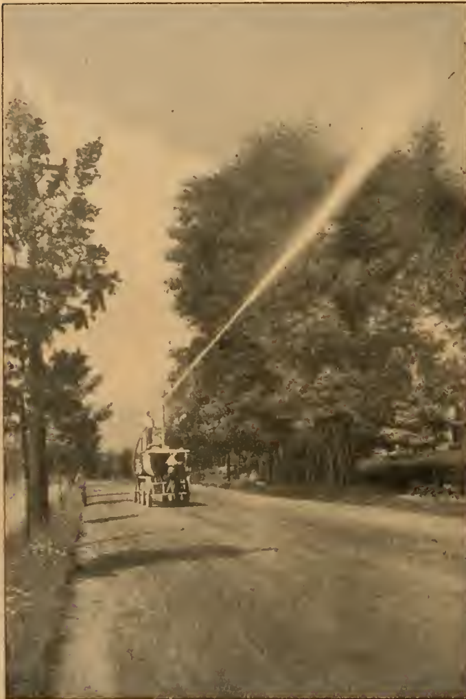
Amerikanischer Motorspritzwagen in Tätigkeit beim Bespritzen von Straßenbäumen. (Nach Rogers und Burgess, U. S. Dept. of Agriculture, Farmers Bul. 564.)
