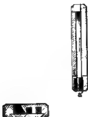
Das in Fig. 149 abgebildete einfache Hebermanometer hat Tunner in seinem „wohlunterrichteten Hammermeister“ 1846 beschrieben. Transportable Windmesser (Reisewindmesser) haben Gahn und Kalstenius angegeben. Die Wassermanometer wurden mehr und mehr durch die handlicheren Quecksilbermanometer verdrängt. 1 Zoll Quecksilber entsprach dem spezifischen Gewicht entsprechend 13,596 (Regnault) Zoll Wasser. Außerdem drückte man die Stärke der Pressung durch Angabe
