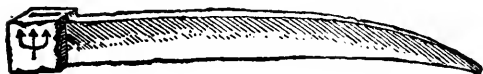
Römischer eiserner Spitzhammer mit der Marke des neptunischen Dreizacks. Fundort Bergstollen bei Pleydt (Nach Dz Witt).
