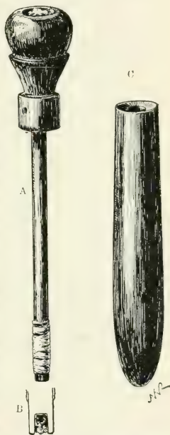
Abb. 28. Pneumatisches Feuerzeug von Südostasien und Borneo. A Stempel, B das untere Stempelende, C das Rohr.
