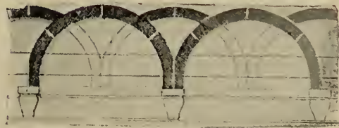
Neuer Fries an der westlichen Aussenwand.
