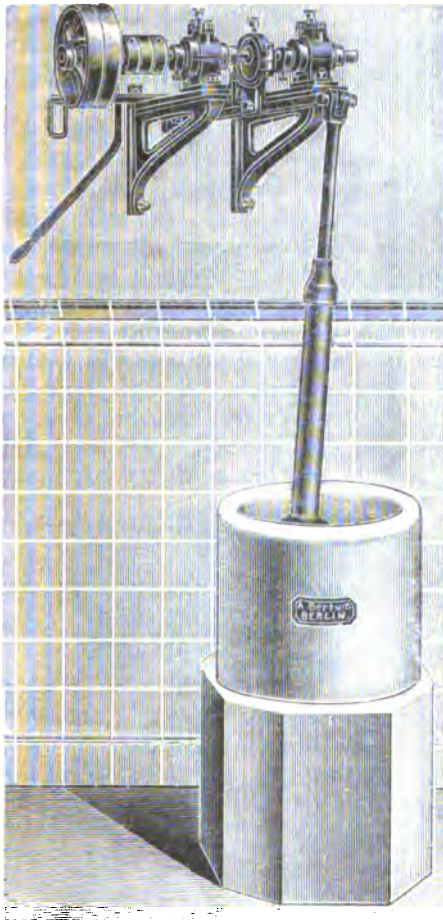
Fig. 2. Marmor-Mörser für Kraftbetrieb. Schwerste Konstruktion mit Vorgelege, fester und loser Riemenscheibe nebst Riemenaustrücker, Pockholzkeule und Holzsockel. Außerer Durchmesser des Mörsers 45, 50 cm.
