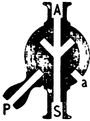
Fig. 7. Schema des Dreivegehähns für die Sicherheitsnadel. Verbindung zwischen Nadel und Aspirations-spritze. A Nadelansatz, S Spritzenansatz, P Schlauchansatz zur Verbindung mit dem Stickstoffapparat, a Öffnung nach außen.
