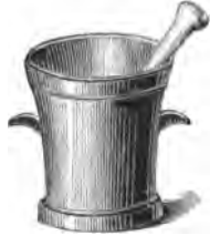
Fig. 7. Standmörser von Gußeisen mit Pistill.
