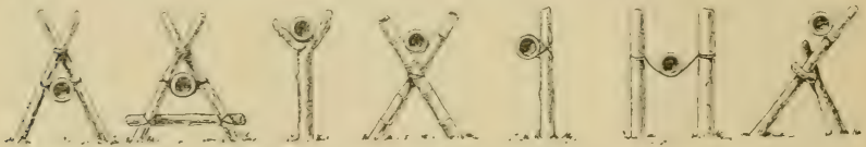
Fig. 18. Stützen für Wasserleitungsrohre.
