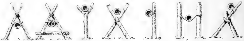
Fig. 18. Stützen für Wasserleitungsrohre.
