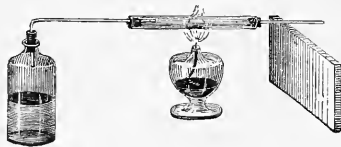
Fig. 59. aus Zink und verdünnter Schwefelsäure Wasserstoffgas entwickelt. In die weite Röhre bringe man eine Messerspitze voll schwarzes Kupferoxyd und
