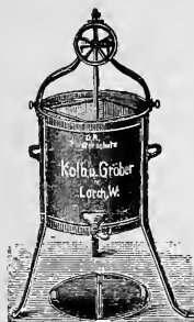
Fig. 45. Selbstregulierende Honigschleuder von Kolb & Gröber in Lorch.
