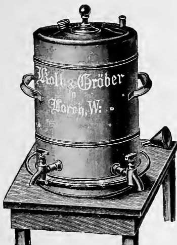
Fig. 46. Honig- und Wachsklärapparat von Kolb & Gröber in Lorch.
