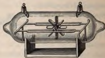
Fig. 185. Wirkung der Kathodenstrahlen auf ein Glimmerrädchen.
