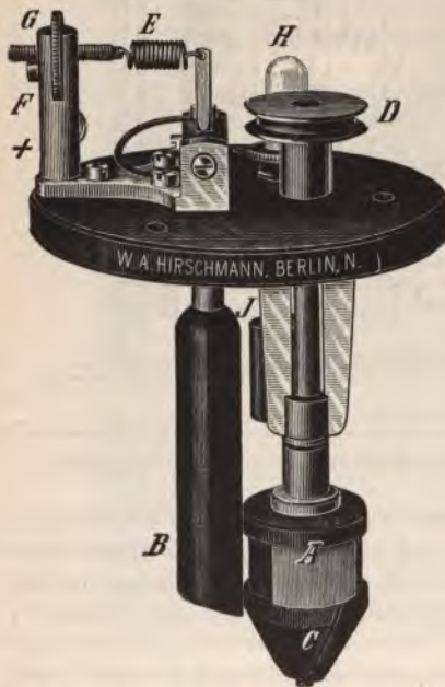
Fig. 179. Unterbrecher von HIRSCHMANN aus seinem Gefäß herausgenommen.
