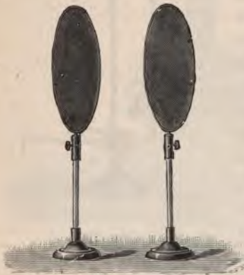
Fig. 192. Metallschirme zur Erzeugung eines Hochspannungsfeldes.
