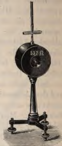
Fig. 110. Spiegelgalvanometer mit Astasierungsmagnet.
