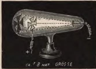
Fig. 184. Geradlinige Ausbreitung der Kathodenstrahlen.
