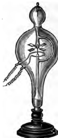
Fig. 186. Wirkung der Kathodenstrahlen auf ein Radiometer.
