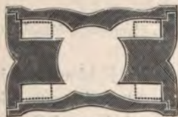
Fig. 144. Außenpolmaschine mit Ringmagnet.
