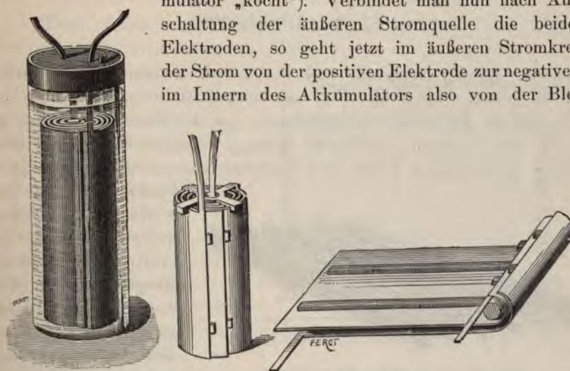
Fig. 85. Akkumulator nach PLANTÉ.
