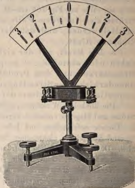
Fig. 107. Vertikalgalvanometer zu Demonstrationszwecken.
