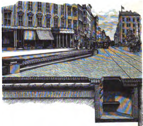
Leitungsführung in Broadway.
