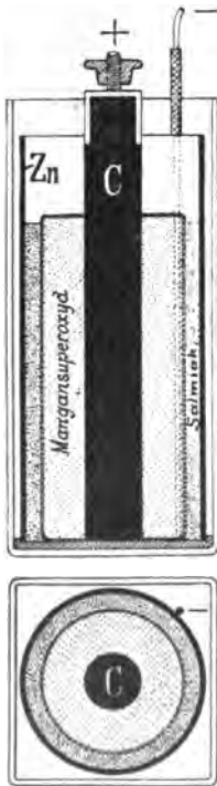
Fig. 97. Längs- und Querschnitt durch eine Hellesensche Zelle.
