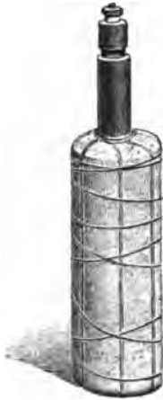
Fig. 96. Gasebeutel mit Kohlestab und Mangansuperoxydbrei.
