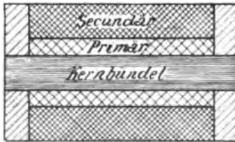
Fig. 295. Induktionsrolle im Längsschnitt.
