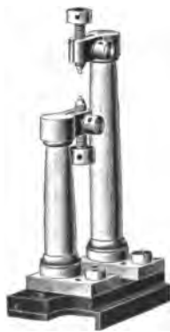
Fig. 190. Isolierte Anschläge am Übertragungs- Farbschreiber.
