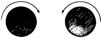
Fig. 29. Uhrzeigerregel für die Polarität eines Elektromagneten.
