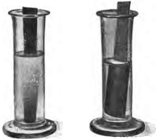
Fig. 84. Gewöhnliches und amalgirtes Zink in verdünnter Schwefelsäure.
