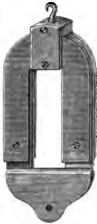
Fig. 15. Hufeisenmagnet, aus Lamellen zusammen- gesetzt und mit Anker.
