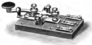
Fig. 164. Klopfertaste, für amerikanischen Ruhestrom geschaltet.
