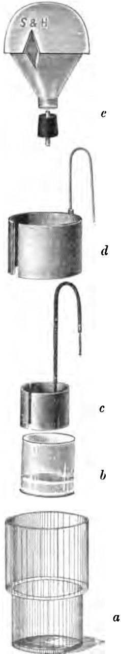
Fig. 92. Meidingersches Element, in seine Bestandteile zerlegt.
