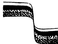
Fig. 127. Zerrissene Flexur mit Schleppung.
