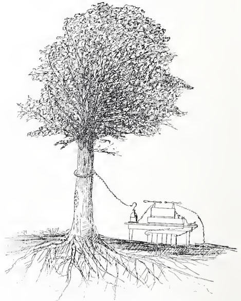
19. — SISTEMA GUARINI-PALUMBO PER DISTRUGGERE GLI INSETTI COLL'ELETTRICITÀ.
