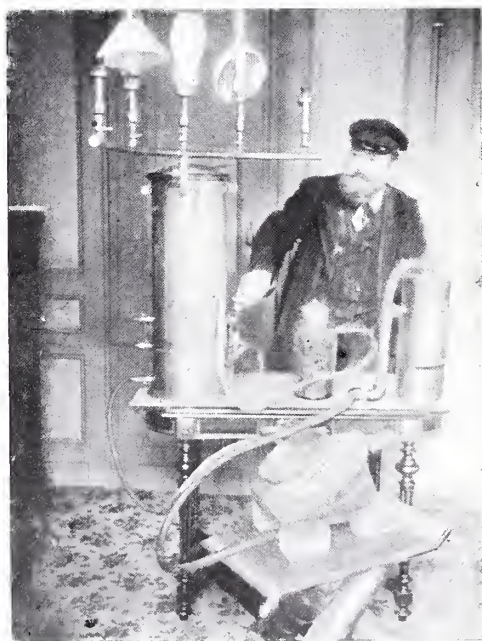
4. — APPARECCHIO TOBIANSKY PER LA DISTRUZIONE ED UTILIZZAZIONE DEL FUMO.
