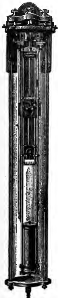
FIG. 30.—Hipp Electrical Clock (Peyer, Favarger et Cie.).
