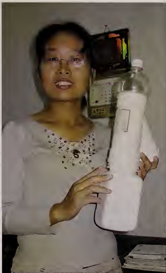
10. Large white 75 mm UPVC (Unplasticised PolyVinylChloride or rigid PVC) collector for Malaise traps (Hangzhou type) with 1 l bottle. Photo: C. van Achterberg 10. Grote witte 75 mm UPVC verzamelpot voor Malaisevallen met 1 l plastic pot.
