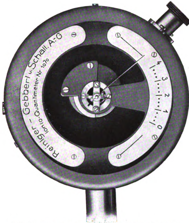
Abb. 73. Skala des Iontioquantimeters von Reiniger, Gebbert und Schall.
