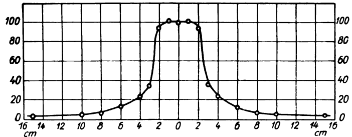
Abb. 118. Ionisation in bestimmter Wassertiefe für verschiedene Abstände vom Zentralstrahl nach Krönig und Friedrich.
