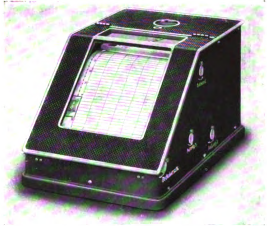
Abb. 81. Registriergerät zum Siemens-Röntgen-Dosismesser.
