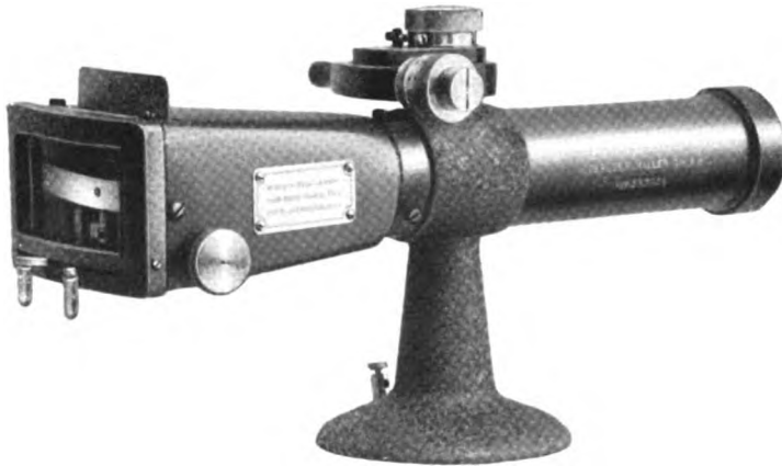
Abb. 14. Röntgenspektrometer von March, Staunig und Fritz.
