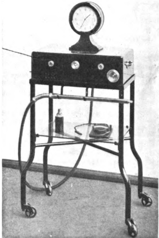
Abb. 86. Dosiszähler nach Jaeger.
