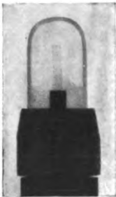
Abb. 53. Röntgenaufnahme der Fingerhutkammer des Siemens-Röntgen-Dosismessers.
