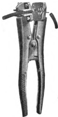
Abb. 1. Zange zur Entfernung der Isolation.
