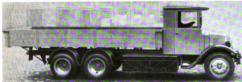
Abb. 1. Akkumulator-elektrischer 5 t-Lastwagen der Hansa-Lloydwerke mit 3 Achsen.
