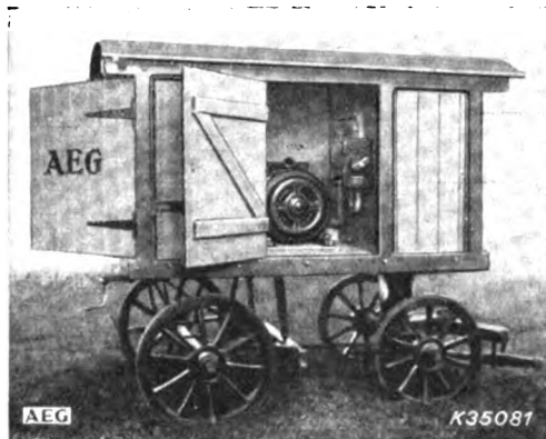
Abb. 2. Motordreschwagen mit eingebautem Stahlmotor.
