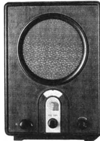
Abb. 3. Empfänger in Preßstoffgehäuse.
