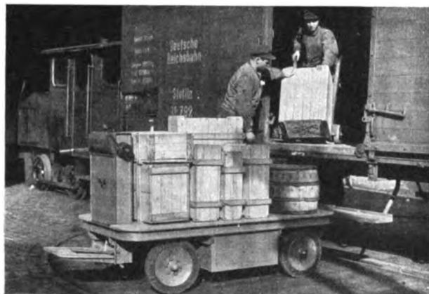
Abb. 3. Hansa-Lloyd-Elektrokarren mit 1500 kg Tragfähigkeit.
