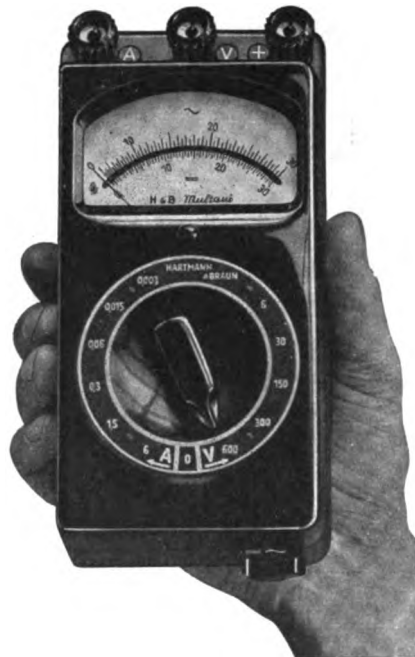
Abb. 1. Universal-Meßgerät Multavi II für Gleich- und Wechselstrom.
