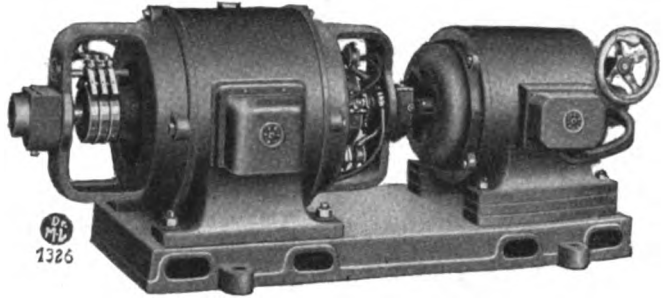
Abb. 2. Eichmaschinensatz mit Drehtransformator.
