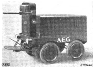
Abb. 3. AEG-Elektroschlepper für das Ziehen von Anhängelasten im Gesamtgewicht bis zu 8000 kg.
