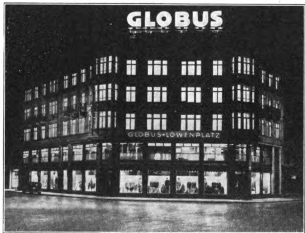
Abb. 13. Anleuchtung eines Dachschildes mit 6 Natriumdampflampen von je 120 W.
