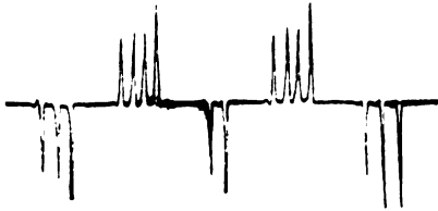
Abb. 2. Oszillogramm des Stromes einer Leuchtröhrenanlage
