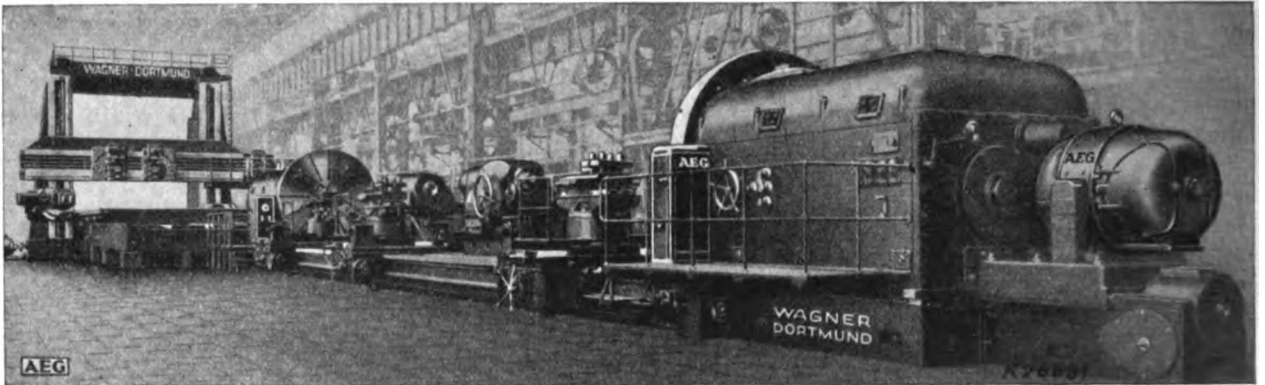
Abb. 2. Doppelte Spitzendrehbank 1500 x 20000 mm und Hobelmaschine 5250 x 12000 mm mit zusammen 31 Motoren
