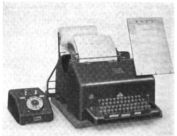
Abb. 5. Fernschreibstelle. Fernschreibmaschine und Reikasten mit Wählscheibe.
