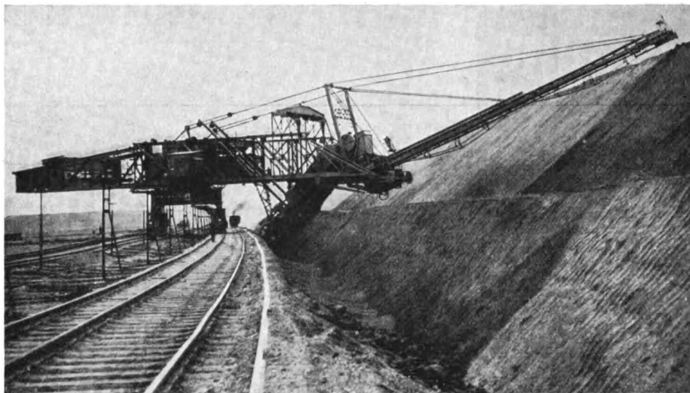
Abb. 1. Absetzgerät mit um 360^\circ schwenkbarem Oberbau für wahlweise Hoch- und Tiefschüttung in beliebiger Winkelstellung zur Gleisanlage und für Schüttung vor Kopf. Ausladung 53 m. Schütthöhe 18 m.
