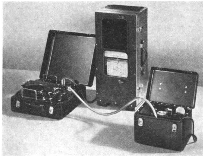
Bild 4. Tragbarer Tintenschreiber mit lichtelektrischem Verstärker.
