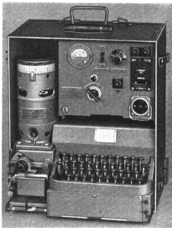
Bild 10. SH-Feldfernrechner, ortsbewegliche Ausführung mit Geber, Schreiber und Anschlußgerät.
