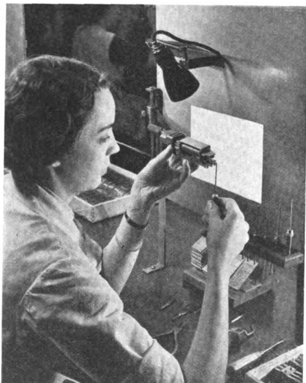
Bild 7 Auswiegen des Kontaktdruckes bei Fernmelderelais.
