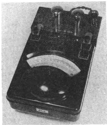
Bild 2. Thermoelektrischer Leistungsmesser mit Lichtmarkenmeßgerät.
