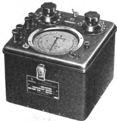
Bild 5. Neuer Gleichlastprüfzähler für Drehstrommessungen.
