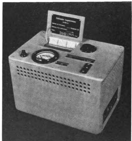
Bild 3. Stroboskopischer Frequenzmesser für einen Meßbereich von 10 bis 1000 Hz.
