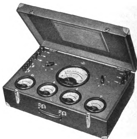
Bild 4. Meßkoffer für Strom-, Spannungs- und Leistungsmessung von Drehstrom ungleicher Belastung.
