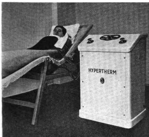
Bild 6. Zweiröhrensender für Kurzwellen-Fieberbehandlung.
