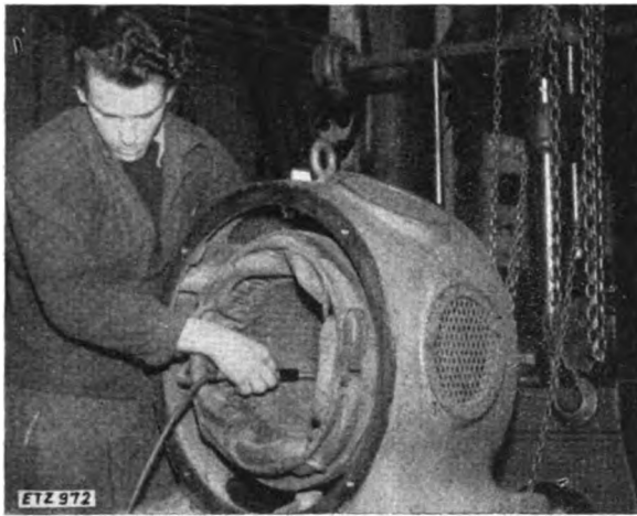
Bild 2. Prüfung eines Drehstrom-Ständers.
