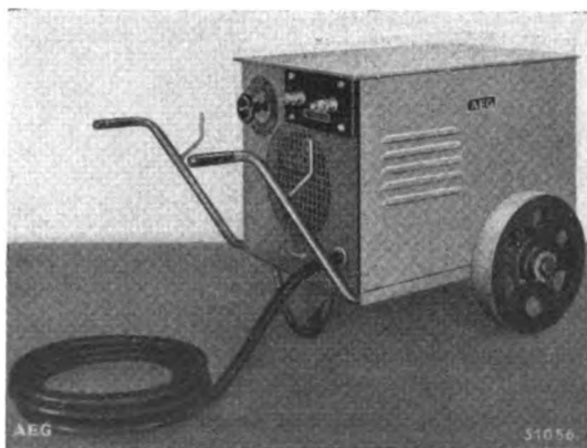
Schweißwandler Typ LSW 6 Schweißstrombereich 75 A bei 15 V bis 380 A bei 35 V stufenlos einstellbar
