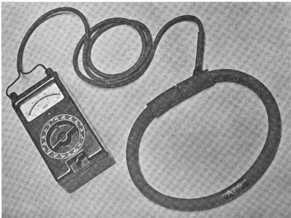
AEG-Strommeßband zum Messen sekundärer Schweißströme
