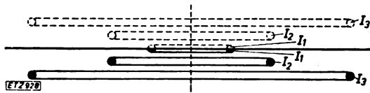
Bild 6. Drei konzentrische Ringerder mit 3 m, 6 m, 12 m Durchmesser und 0 m, 0,5 m und 1 m Verlegungstiefe und deren Spiegelbilder. Originale und Spiegelbilder führen die Ströme I_1, I_2, I_3 .
