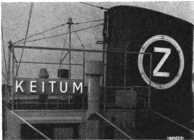
Bild 7. Erste Leuchtröhrenanlage an Bord.
