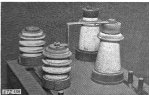
Bild 4. Normstützer und Rillenstützer 10 kV in Verschmutzungsraum (vordere Stützer unter Spannung verschmutzt).
