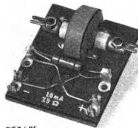
Bild 36. HF-Stromwandler-Thermo- umformeranordnung 2,5 A, 34 ... 41 MHz.
