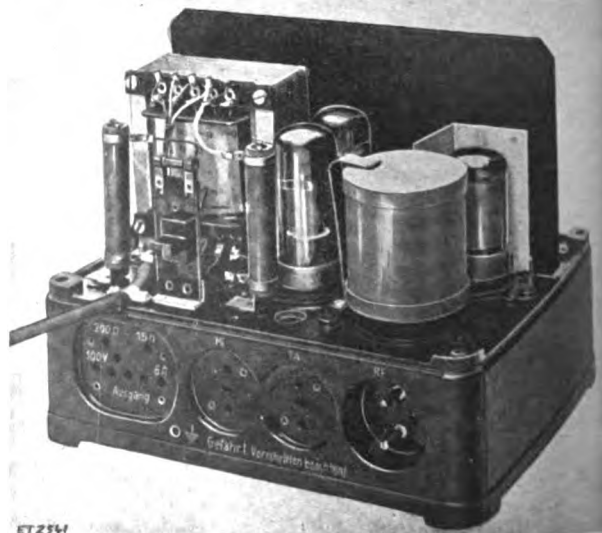
Bild 29. Allzweckverstärker (Chassis von hinten gesehen).
