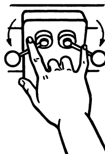
ETZ 894 Bild 2. Umgehungsmöglichkeit einer Zweihand-Einrückung bei falscher Anordnung der Betätigungselemente.
