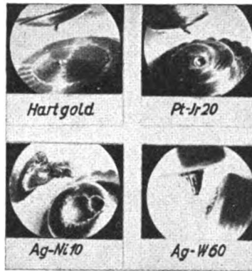
ETZ 232 Bild 5. Spitzenbildung bei der Feinwanderung; 8 V, oben 3 A, unten 30 A.
