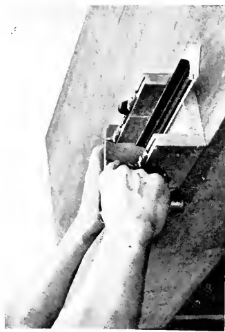
Sawing a Mitre in the Mitre-box
