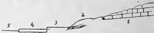
FIG. II. — Coupe des bords du lac d'Arzeu. 1. Grès pliocène supérieur démantelé. — 2. Bourrelet de sable. 3. Banquette de grès. 4. Dépôt de sel. — 5. Eau saturée de sel.
