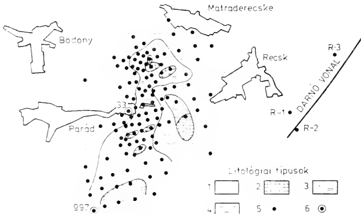
3. ábra. A reस्कi terület alaphegység-felszínének litológiai térképe. J e l m a g y a r á z a t: 1. Felső/alsó agyapala csoport: agyapala, homokkő, kevesebb kvarcit, aleurit, mészkő, 2. Felső/alsó mészkő csoport: mészkő, tűzköves mészkő agyapala- és kvarcitközbetelepülésekkel, 3. Felső/középső/alsó kvarcit csoport: kvarcit, kovás aleurit, kovamárga mészkőközbetelepülésekkel, 4. Andezit intrúzió, 5. Fűrólyukak, 6. Az alaphegység tengerszintre vonatkozó minimális és maximális mélysége a kutatási területen
