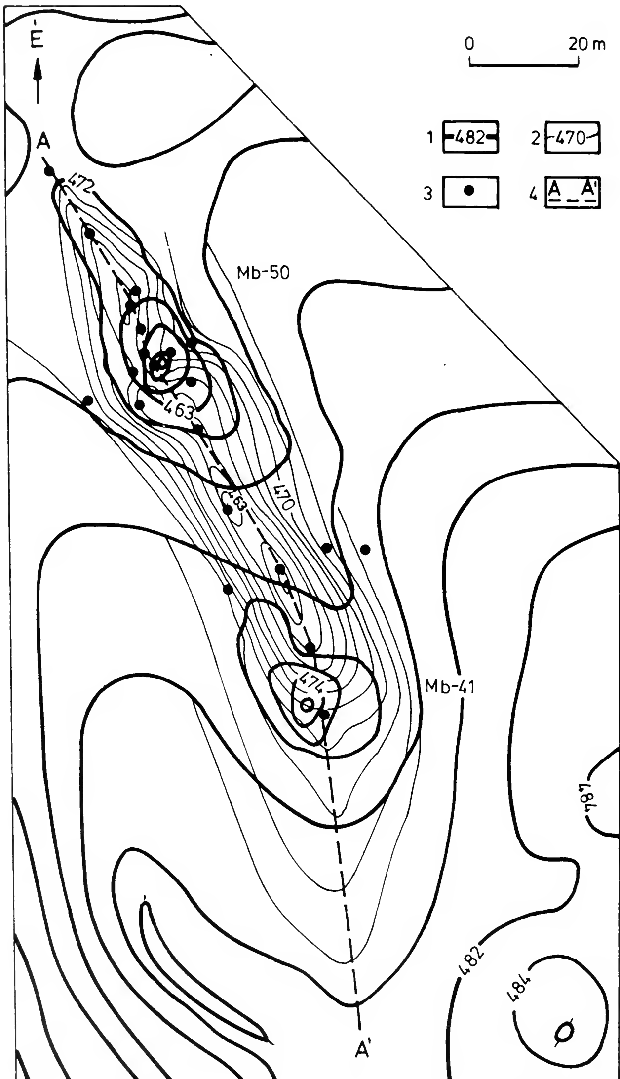
4. ábra. Az Mb-50 és Mb-53 jelű karsztos mélyedések környékén a fekdomborzat térképe. J e l m a g y a r á z a t : 1. A felszín szintvonala, 2. A mészkőfekű szintvonala, 3. Fúrás helye, 4. Az A-A' szelvény helye.
