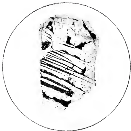
Fig. 26. Aufgewachsener Plagioklaskrystall mit Einschlüssen von Ilmenit.
