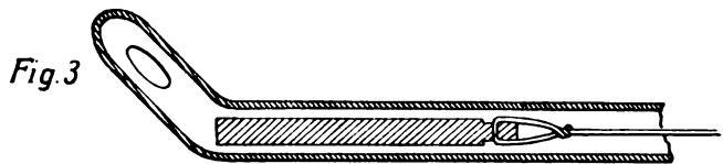
Fig. 3 Längsschnitt des halbstarren Katheters mit einziger Öffnung und der Radiumröhre.
