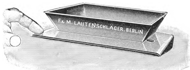
Schalenwippe nebst kleinem Entwicklungsgefäss.
