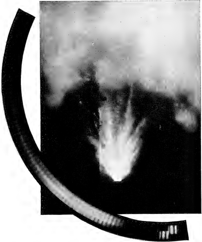
Photographisches Flammenbild von Pikrinsäure: Doppelflamme, davon die erste klein, von kurzer Dauer, die zweite umfangreich, wolkenartig, relativ lange andauernd. Abstand der beiden Flammen, sowohl örtlich wie zeitlich, merklich größer als in Fig. 11.
