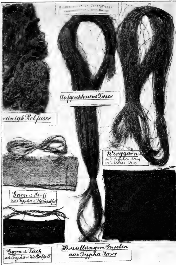
Abb. 3. Herstellung von Garnen und Geweben aus den Blattfasern vom Kolbenshilf ( Typha angustifolia ).
