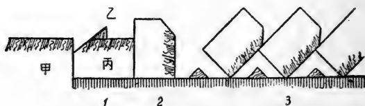
第 38 圖 應用具有犁頭鐵的螺旋犁進行犁耕時壟條的情況 1——犁刀(甲)、犁頭鐵(乙)和犁鏟犁頭(丙)順序行進後壟條的情況; 2——犁鏟犁板行進後壟條的情況;3——壟條的最後情況。
