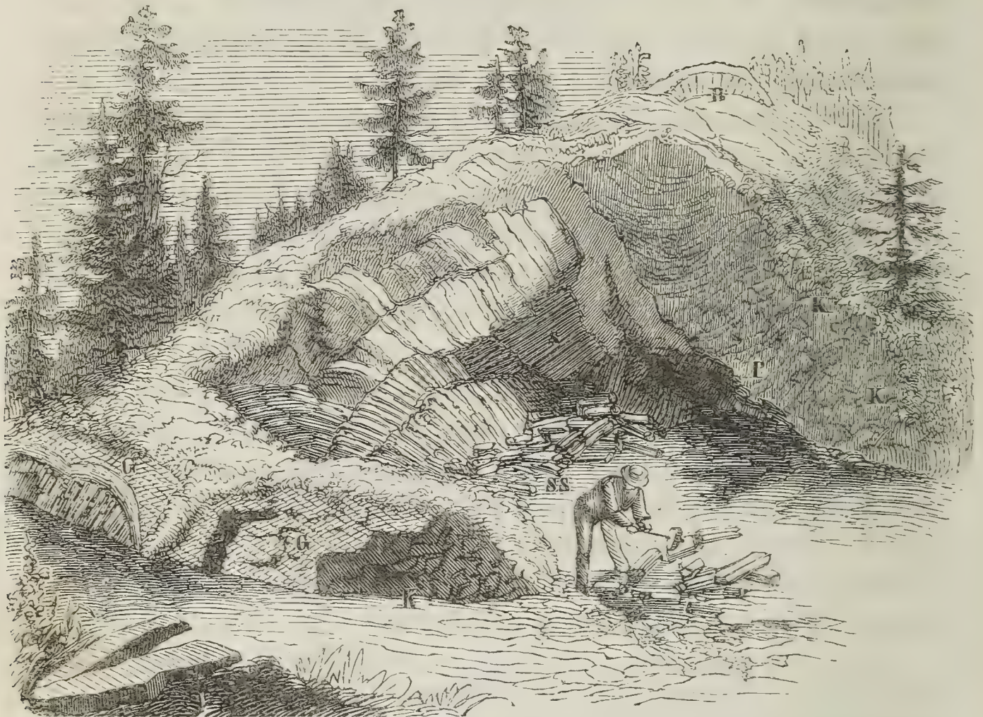
Fig. 53. Basaltbruch am Pinzenberge. B. Säulen am Gipfel. S. Säulenbasalt. P. Plattenbasalt. K. Basaltkonglomerat. SS. Losgebrochene Säulen. G. Granit.
