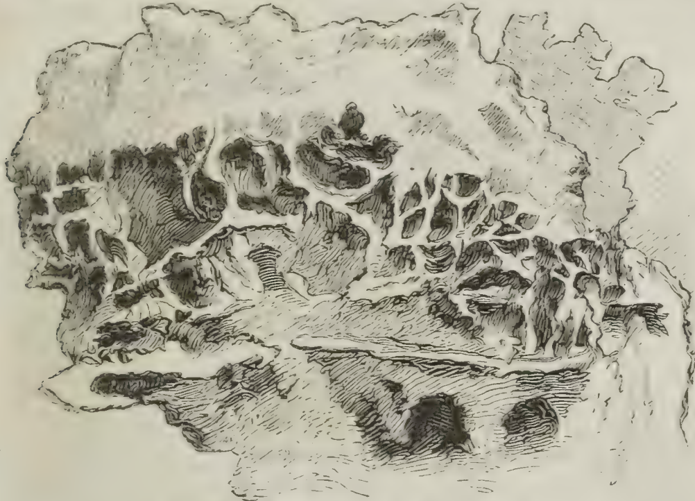
Fig. 99. Auswitterung des Sandsteines.
